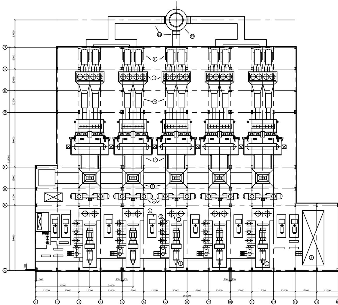
Экспликация основного оборудования главного корпуса ТЭЦ
